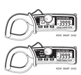
LEAKAGE CURRENT TESTER
