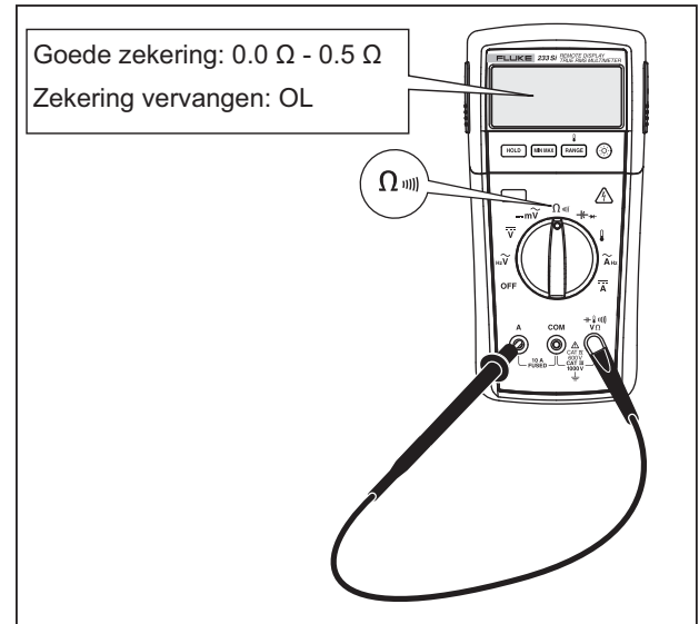
Afbeelding 11. Zekering testen
