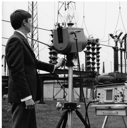
1969: Thermovision model 661. De camera woog ongeveer 25 kg, de oscilloscoop 20 kg en het statief 15 kg. De gebruiker had ook een generatorset van 220 VAC en een 10-liter vat met vloeibare stikstof nodig. Links van de oscilloscoop ziet u het Polaroid-hulpstuk (6 kg).
