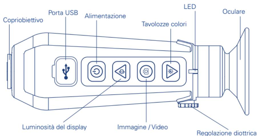
**Caricare Scout TKx** – Utilizzare il cavo USB in dotazione e collegarlo ad una fonte di alimentazione. Il LED lampeggia durante la carica e lampeggia rapidamente in verde quando la carica è completa.
